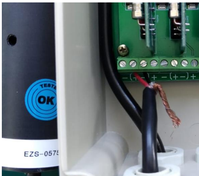
Figura 14 – Ligação do sensor ambiental na barreira
